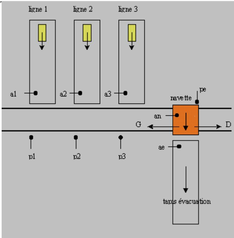
Une navette transporte un par un les produits fabriqués par 3 lignes de fabrication indépendantes vers un tapis roulant d'évacuation selon le schéma ci-contre.
